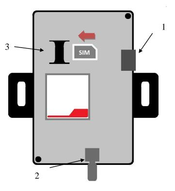
Fig. 2.To insert SIM card
